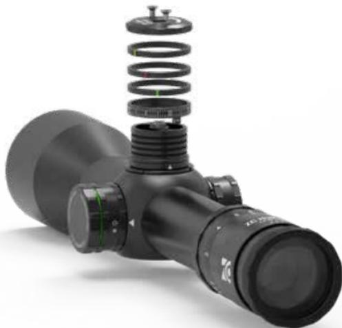
2. Durch Hochziehen der Drehkappe wird diese entsperrt und die Höhe kann durch Klicken verstellt werden. Wenn Sie die Höhenverstellung auf die gewünschte erste Entfernung eingeschossen haben, drücken Sie die Drehkappe wieder nach unten um den Turm zu sperren.
