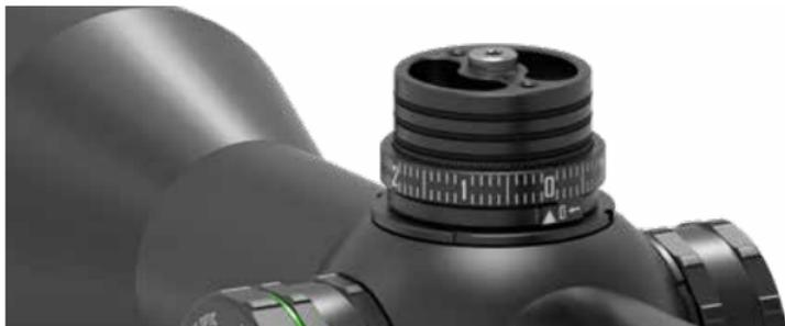
4. Verwenden sie die 3 Indikatorringe um weitere Schussdistanzen zu markieren. Hierzu wird der Turm wieder entsperrt und auf die nächste Entfernung durch Klicken eingeschossen, ohne dabei den Skalenring auf der Drehkappe zu verstellen. Danach kann im versperren Zustand der erste Indikatorring entsprechend der erforderlichen "Klicks" aufgesetzt werden.
