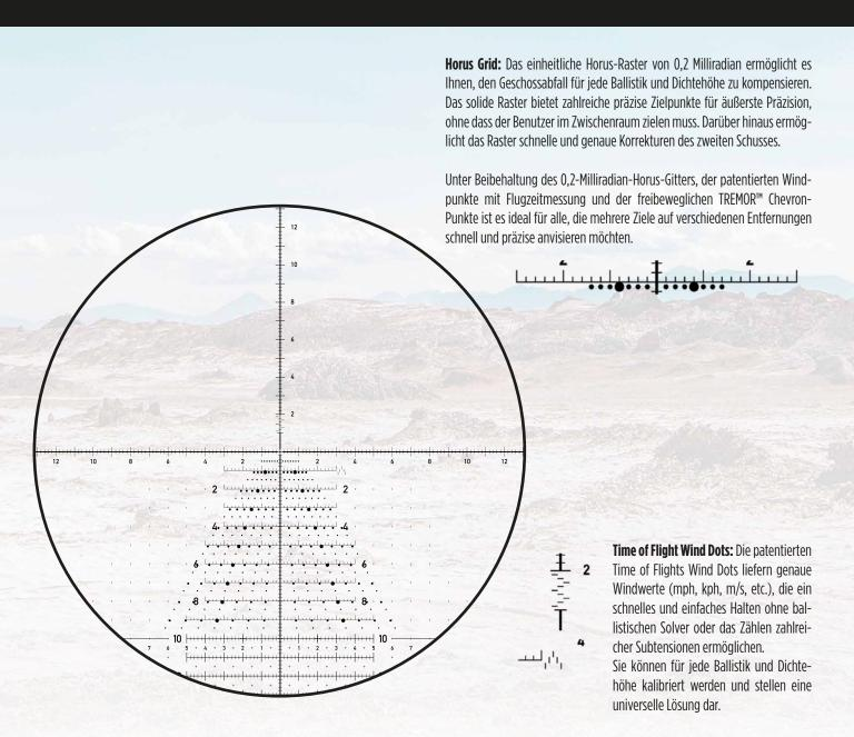
**Präzise Mil-Markierungen:** Präzise "Chevron"-Markierungen im gesamten Absehen mit einer Unterteilung von 0,1 Milliradian sorgen für eine exakte Einschätzung der Zielentfernung. Vertikale Chevrons sind ideal zum Ermitteln der Zielhöhe und die horizontalen Chevrons zum Ermitteln der Zielbreite.
